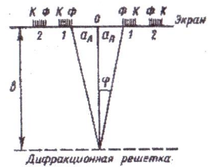
Рис. 1. Ход лучей в дифракционной решетке
